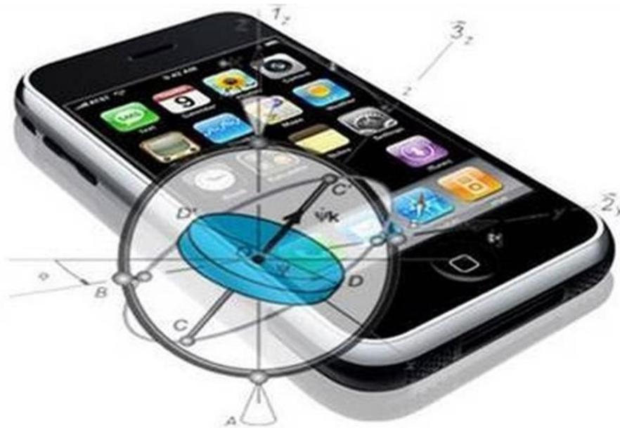
Гироскоп в современном телефоне — датчик, который позволяет автоматически менять ориентацию экрана в зависимости от положения смартфона.
