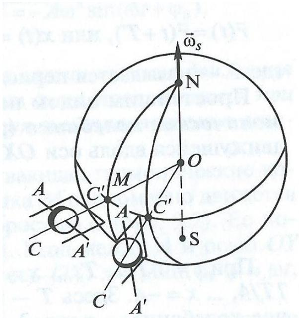
Принцип действия гирокомпаса можно описать с помощью рис. Представим себе гироскоп, установленный на экваторе в некоторой точке  $M$  так, чтобы ось его рамки  $CC$  была вертикальна к поверхности Земли, а ось вращения самого гироскопа  $AA$  в начальный момент времени направлена с запада на восток. Гироскоп будет участвовать в суточном вращении Земли, поворачиваясь вместе с ней вокруг оси  $N - S$  (север – юг) с угловой скоростью  $\vec{\omega}_s$
