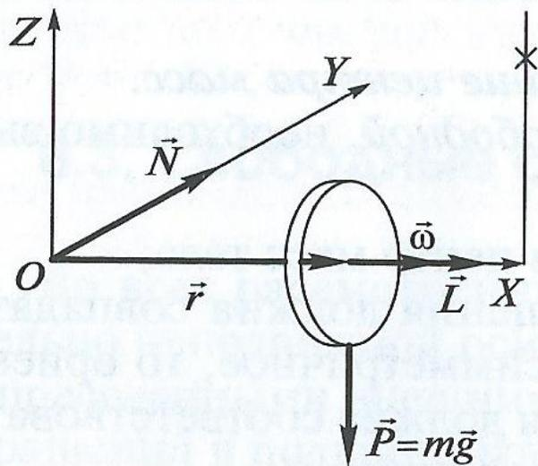
Массивный диск висит на двух нитях и быстро вращается с угловой скоростью  $\vec{\omega}$  гироскоп имеет момент импульса  $\vec{L} = I\vec{\omega}$  направленный вдоль оси  $X$  (рис.).
